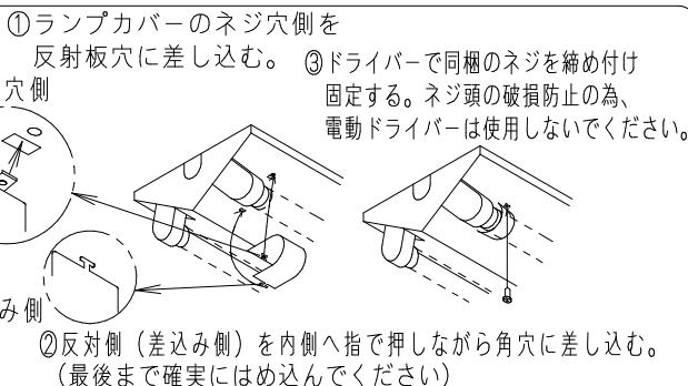
指定以外のランプ使用を防止するため必ずランプカバーを取付けてください。
