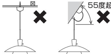
●コードハンガーを使用しない場合傾斜天井不可。傾斜天井にコードハンガーを取り付ける場合はフック開口部が上を向くように取り付けてください。
