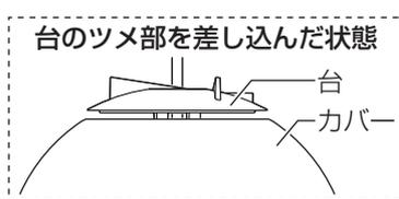
② 電源コードを持ち本体を持ち上げた状態で台を少し左に回して下におろし、本体にはめ込む。
