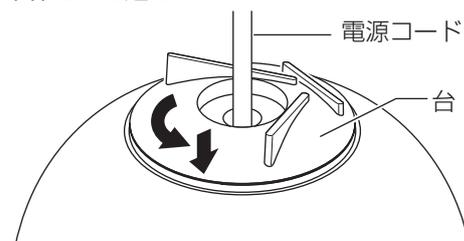
③ 電源コードを持ち本体を持ち上げた状態でナットを右に回して締め付ける。
