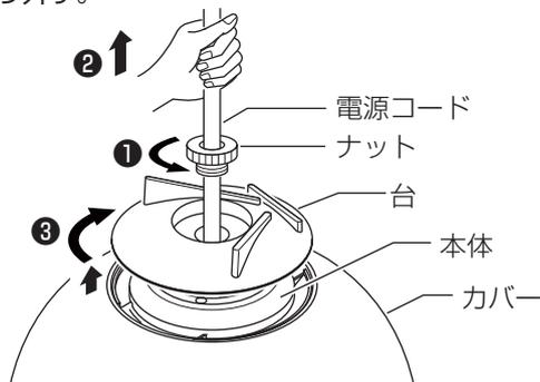
④ カバーを持ち上げ、本体の切欠き（2カ所）にカバー開口部を沿わせながらカバーを取り外す。
