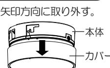
※外れない場合は、カバーを左に回してから矢印方向に取り外して下さい。
