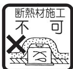
器具は、断熱材・防音材・造営材などと下図のような空間を設けて施工してください。
