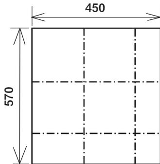
1. フィルタホルダに合わせて、カッターナイフなどで195×195にカットしてください。図のようにフィルタ1枚あたり4枚取れます。
