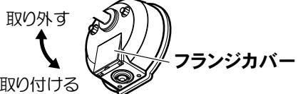
フランジカバーは必ず取り付けて使用してください。フランジカバーを外したまま使用すると水が浸入し、感電、故障の原因となります。
