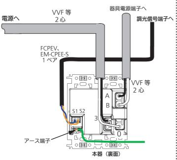
■ 2ヵ所点滅の場合 (別途、3路スイッチを使って照明器具の電源を2ヶ所で入切)
