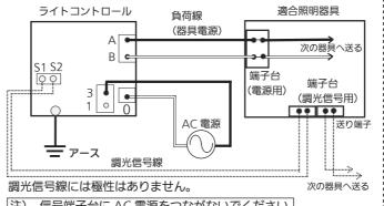
注) 信号端子台に AC 電源をつながないでください。 内部の回路が一瞬でこわれます。
