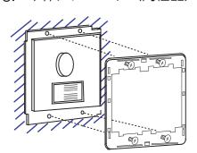
プレート枠(同梱品)を付属ネジで取付板につけます。
