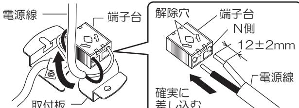
・電源線差し込み後、取付板の中央にくるように電源線を曲げてください。
