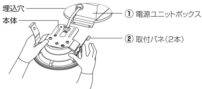
●傾斜天井に取り付ける場合は、傾斜方向の上下に取付バネがくるように取り付けてください。
