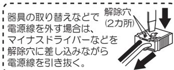
器具の取り替えなどで電源線を外す場合は、解除穴(2カ所)に差し込みながら電源線を引き抜く。
