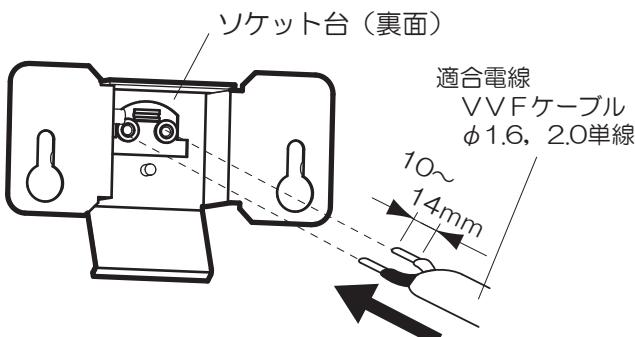
器具の取り替えなどで電源線を外す場合は、マイナスドライバーなどで解除ボタンを押しながら電源線を引き抜く
