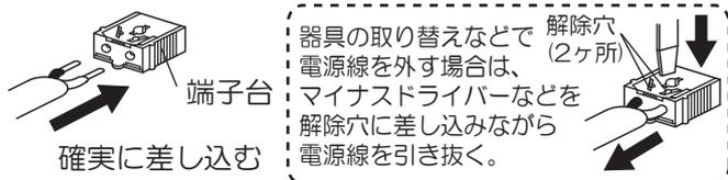
③余分な電源線は電源穴に確実に押し込む。
