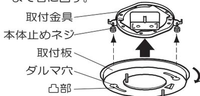
③ドライバーで本体止めネジを締め付ける
