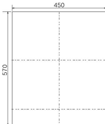
1. フィルタホルダに合わせて、フィルタをカットしてください。図のようにフィルタ1枚あたり4枚取れます。
