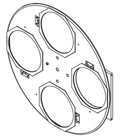
※バンドア、カラーホイルの器具への装着はダブルシート枠の前枠への装着となります。
