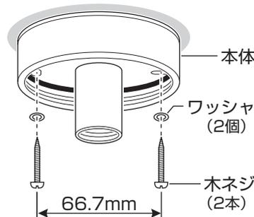
本体パッキン裏面の突起が天井面の電源線引き込み穴にはまるように本体を取り付けてください。
