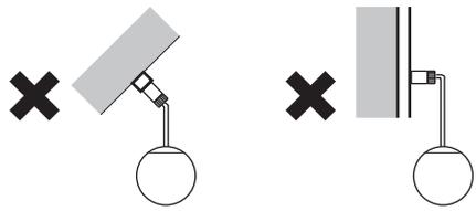
◎この器具は配線ダクト水平天井吊り下げ専用です。
