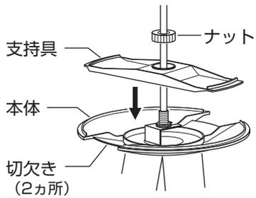
② 本体の切欠き (2カ所) にカバー開口部を沿わせながら、カバーを取り付ける。
