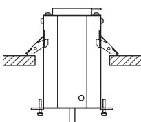
④取付金具を引き下げ、埋込本体を固定する
