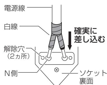
器具の取り替え等で電源線を外す場合は、 $\phi 1.6$ の単線で解除穴を押しながら電源線を引き抜く。
