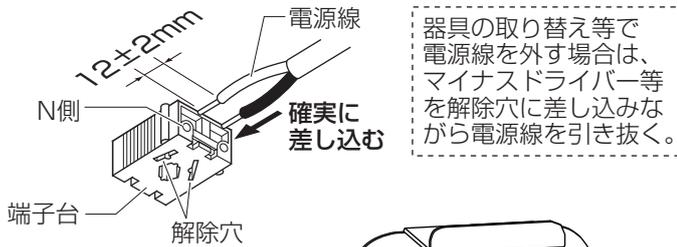
・接続後、電線線を矢印の方向に回してください。
