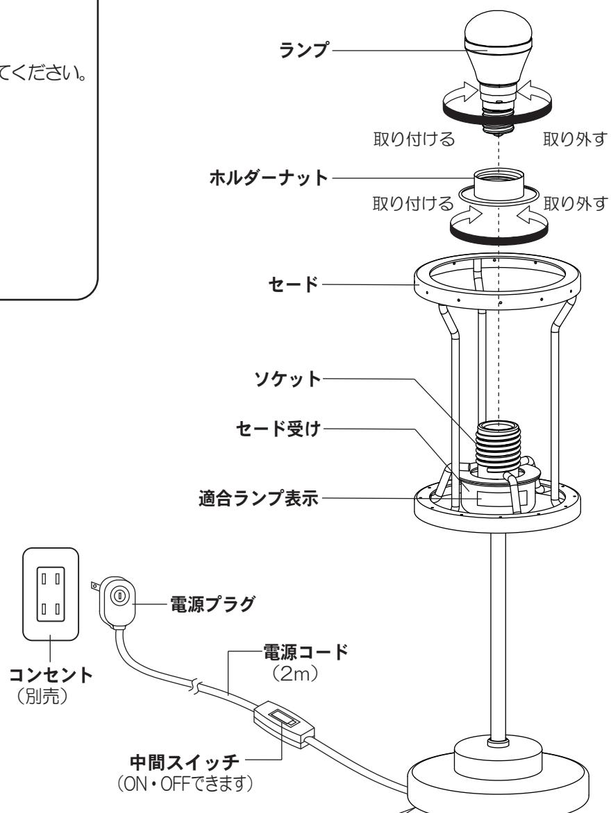
スタンドが転倒したり、フランジが床から浮いた状態で使用されますと、ランプが消灯します。
