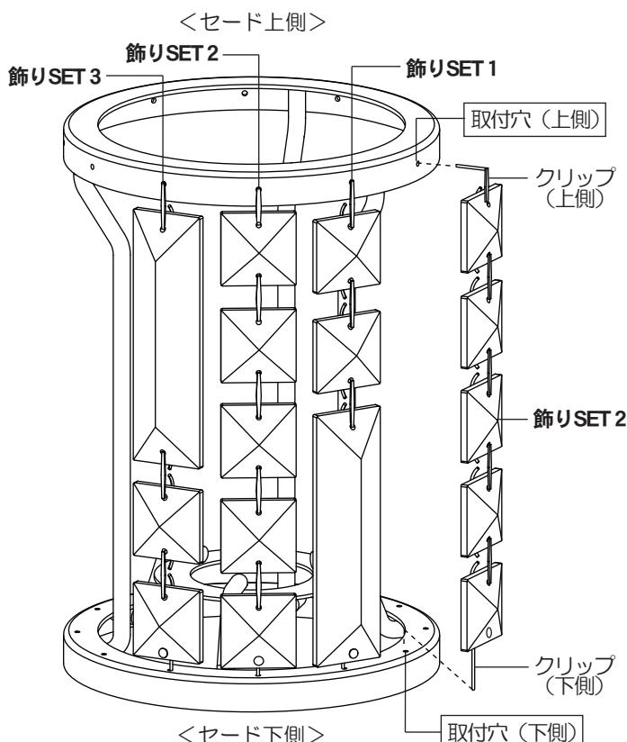
①飾りSET2のクリップ（上側）を取付穴（上側）に取り付け、クリップ（下側）を取付穴（下側）に取り付ける。
