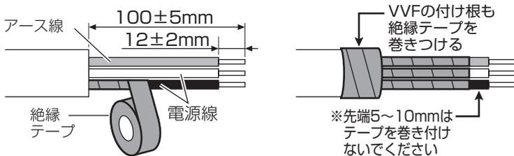
(注意)VVFφ2.0は電線が硬いため、器具が浮き上がり、正しく設置できない場合があります。
