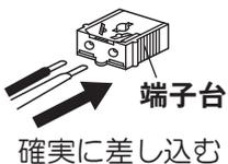
器具の取り替えなどで電源線を外す場合は、解除穴（2カ所）を解除しながら電源線を引き抜く。
