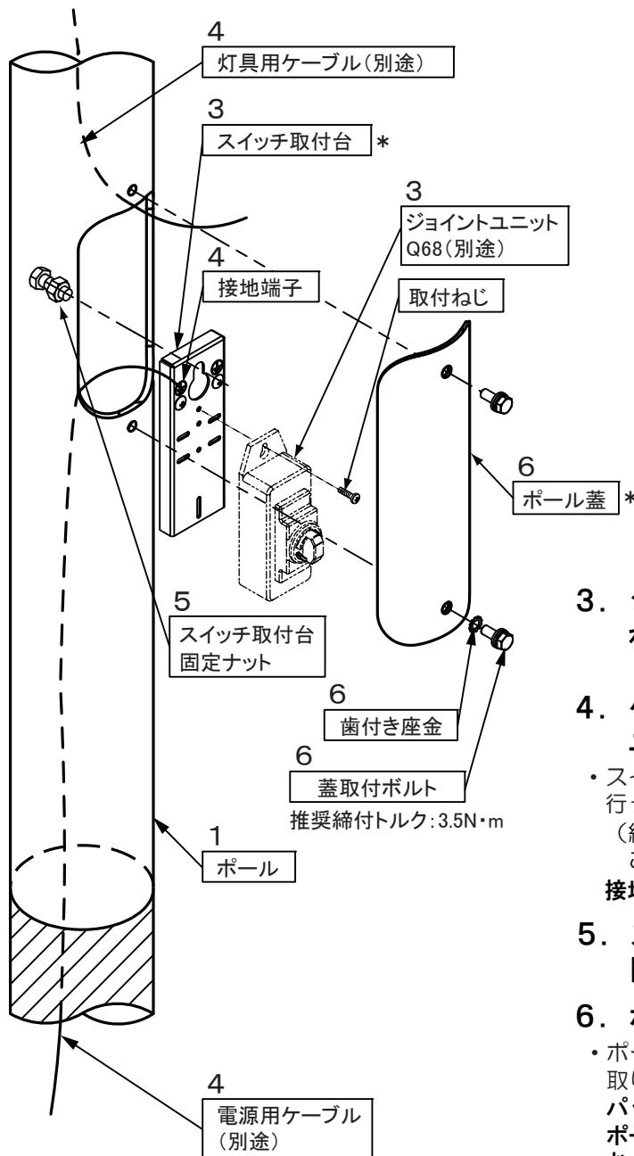
3. ジョイントユニットQ68（別途）を付属のねじでスイッチ取付台に取り付ける。
