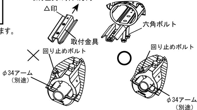
回り止めボルトが確実に締め付けられていること。
