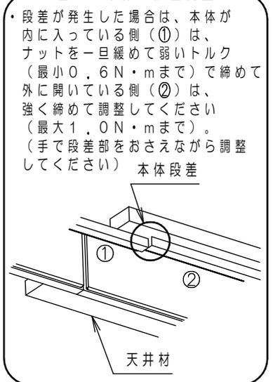
図3 パネルの段差調整方法
