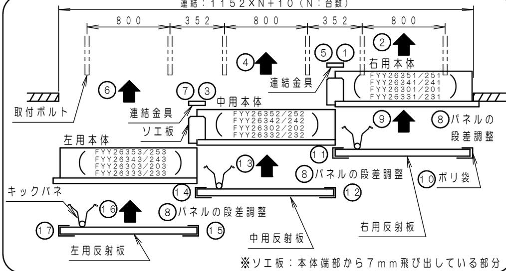
図2 本体の段差調整
