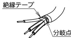
分岐点・余りな電線が器具外部に戻されている
