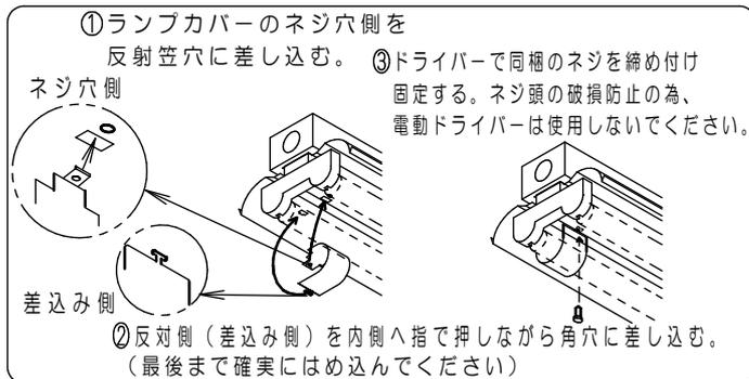
指定以外のランプ使用を防止するため必ずランプカバーを取付けてください。
