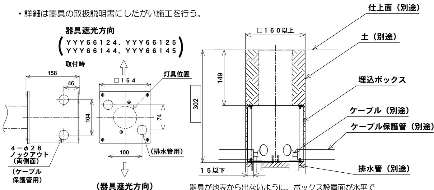
器具が地表から出ないように、ボックス設置面が水平で平滑になるように仕上げ及び高さ調整してください。
