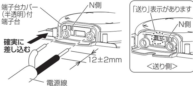
電源線の取り外しかたは、マイナスドライバーなどで解除ボタンを押しながら電源線を引き抜く。
