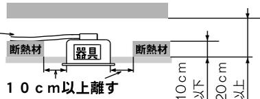
器具は、断熱材、防音材、造営材と左図のような空間を設けて施工してください
