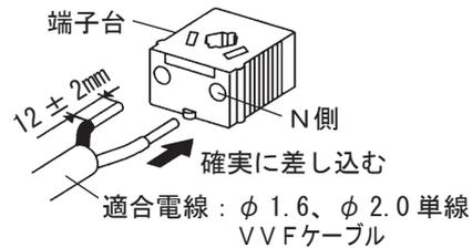
器具の取り替えなどで電源線を外す場合はマイナスドライバーなどを解除穴に差し込みながら電源線を引き抜く。
