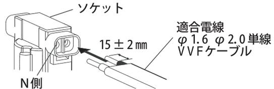
器具の取り替えなどで電源線を外す場合は、マイナスドライバーなどを解除穴に差し込みながら電源線を引き抜く。
