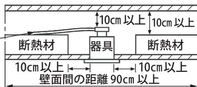
断熱施工されていない天井に取り付ける場合器具は、防音材・造営材などと下図のような空間を設けて施工してください。
