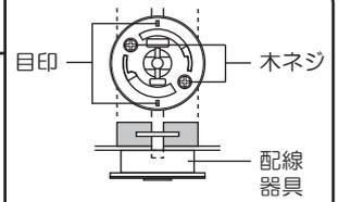
天井に下図のような配線器具が付いている場合、取り付けできます。
