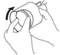
①ランプのピンをソケットのピン穴に差込む。
