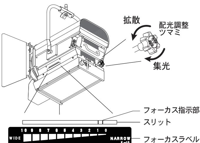
配光の調整は、灯体後部の配光調整ツマミを回転させて行ってください。
