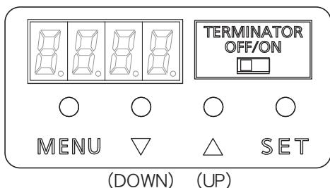
器具の設定変更は、下図を参考にして、MENUスイッチ、UP-DOWNスイッチ(△・▽)、SETスイッチ操作によってメニュー内を移動して行ってください。
