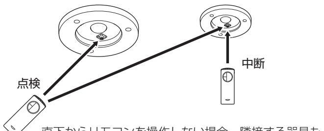
直下からリモコンを操作しない場合、隣接する器具も受信してしまうことがあります。その際は隣接する器具の直下から、リモコンの「中断」スイッチを押して点検を中断してください。
