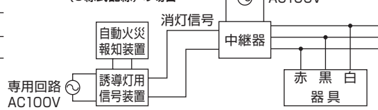
E. 自火報連動による100%点灯あり・信号装置消灯あり(3線式配線)の場合
