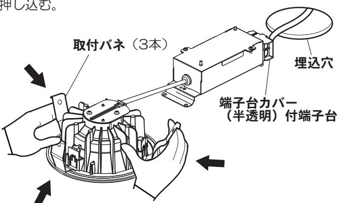
●石こうボードに取り付けた器具を取り外す場合は、枠部をゆっくり引き下げて取付バネ(3本)を押し曲げながら取り外してください。
