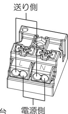
器具の取り替えなどで電源線を外す場合はマイナスドライバーなどで解除ボタンを押しながら電源線を引き抜く。
