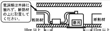
断熱材・防音材・造営材等の空間については、LEDダウンライトの施工説明書を参照してください。
