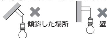
◎この器具は配線ダクト水平天井吊り下げ専用です。
