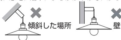
◎この器具は配線ダクト水平天井吊り下げ専用です。
