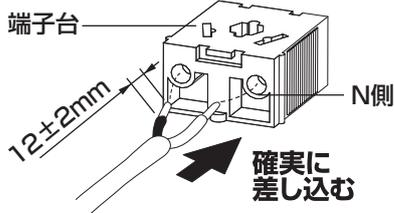
器具の取り替えなど 解除穴で電源線を外す場合 (2ヶ所) マイナスドライバーなどで解除穴を押しながら電源線を引き抜く
