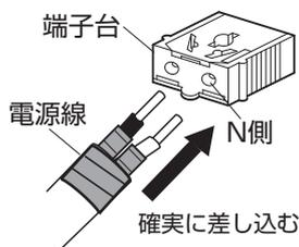
器具の取り替えなどで電源線を外す場合、解除穴（2ヶ所）をマイナスドライバーなどで押しながら電源線を引き抜く
