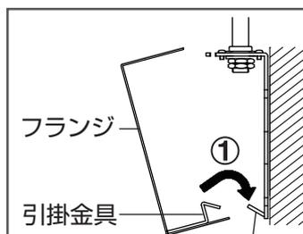
①電源線を壁内に押し込み引掛金具を取付座に引っ掛ける
