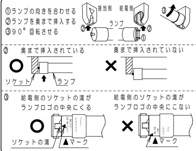
取り付けが不完全な場合、ランプ落下、照度低下の原因となります。
