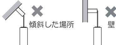
◎この器具は配線ダクト水平天井吊り下げ専用です。
