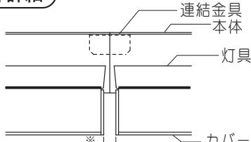
※連結部の隙間は各々均等になるようにカバーの位置を調整してください。また、カバー装着後、長手方向のズレが気になる場合には左右にずらして微調整してください。
