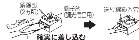
適合電線: FCPEV相当  $\phi 0.9$ ,  $\phi 1.2 \times 1$ ペア
