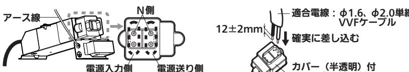
②接地端子ネジよりD種（第3種）接地工事を行う。
