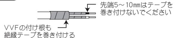
●送り線であることを確認してラベルの結線部分を剥がし図のように配線してください。
