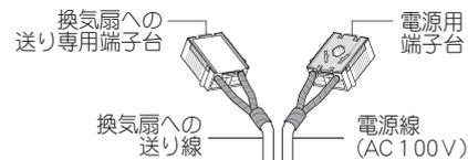
**注意** 換気扇への送り専用端子台に電源線を接続しない。接続する線を間違つと、故障の原因となります。
