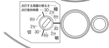
・点灯保持時間を約30秒、約2分、約6分の3段階とひとセンサがはたらきはじめる周囲の明るさを約10lx(暗)、約30lx(明)、無限大(切)の3段階で調整できます。
